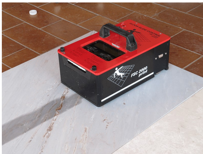
Zkouška protiskluznosti po ošetření přípravkem NOSBRISS.
